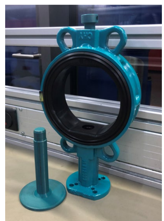
Ebenfalls aus dem 3D-Drucker: die Montagedorne zur besseren Positionierung der Manschette. Das Einkleben der Manschette in den Klappenkörper ist sehr schwierig, weil der Kleber schnell abbindet. Der Montagedorne sorgt für die richtige Positionierung beim ersten Einlegen der Manschette und für weniger Ausschuss.
