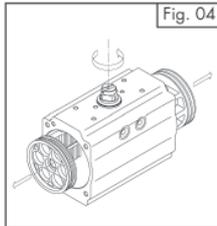
**D. Ausbau der Kolben (Art.-Nr. 40), Bild 04:**
