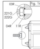
**D. Montage der Einstellschrauben (Art.-Nr. 02) und Hubbegrenzung für die Typen DRSC00015U -> DRSC5000U, Bild 15 und 16:**
