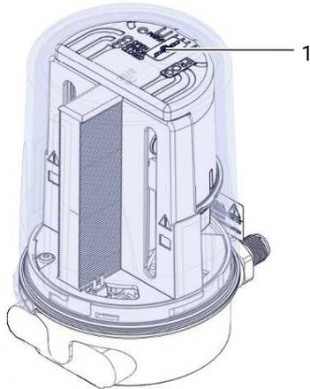
operação). As posições finais da válvula e o sensor de posição integrado poderão ser monitorados via as conexões elétricas.
