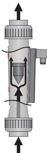
Fig. 1: Principe de fonctionnement du capteur de mesure
