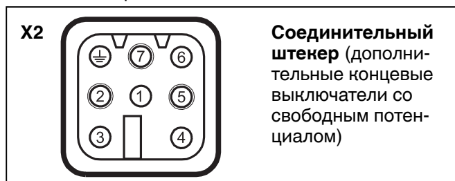
Распределение контактов в штекере X2
