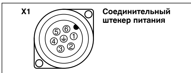
Распределение контактов в штекере X1
