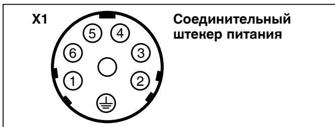
Распределение контактов в штекере X1
