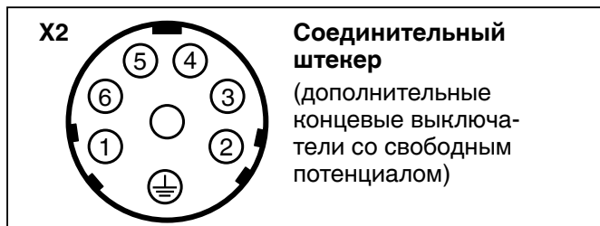
Распределение контактов в штекере X2
