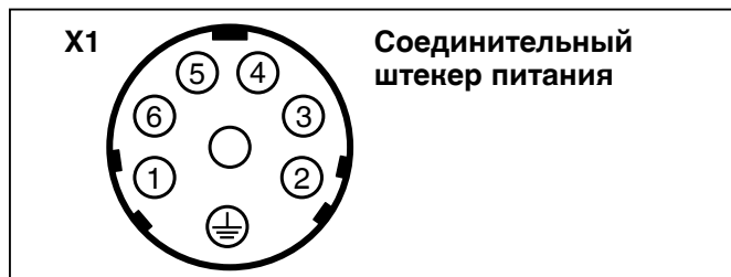
Распределение контактов в штекере X1
