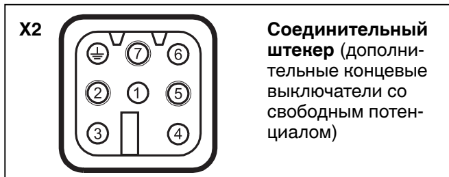
Распределение контактов в штекере X2
