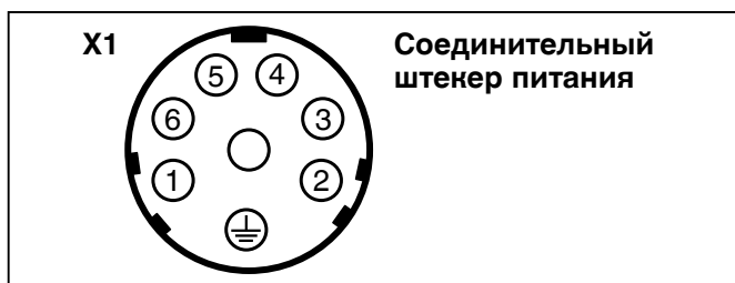
Распределение контактов в штекере Х1
