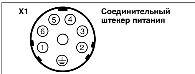
Распределение контактов в штекере X1
