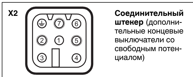
Распределение контактов в штекере X2
