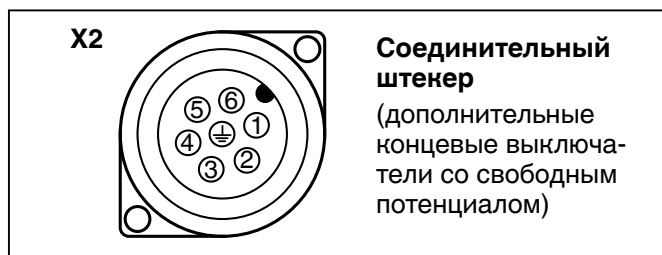
Распределение контактов в штекере X2
