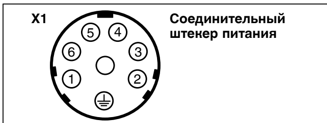
Распределение контактов в штекере X1
