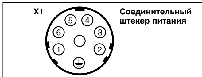
Распределение контактов в штекере X1
