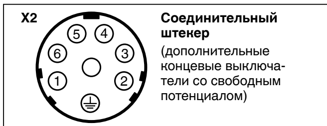
Распределение контактов в штекере X2
