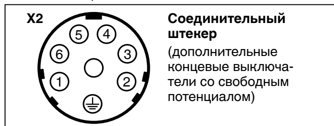
Распределение контактов в штекере X2
