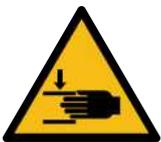
**Quetschgefahr durch steigendes Handrad!**
