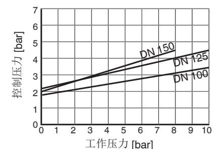
提示：在上述图表中对于“在弹力下打开”(常开)驱动装置给出的是根据工作压力的最小的必要控制压力。
