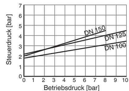
**Hinweis:** In oben stehenden Diagrammen ist bei den Antrieben "unter Federkraft geöffnet" (St.f. 2) der minimal notwendige Steuerdruck in Abhängigkeit vom Betriebsdruck angegeben.
