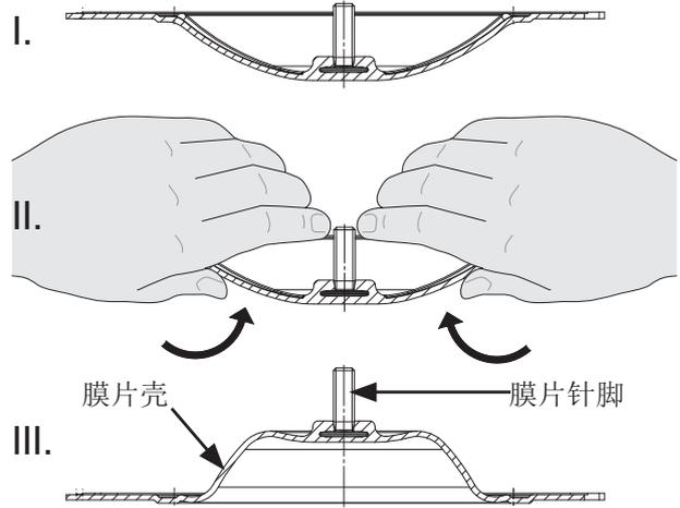
5. 将新的支撑膜片放在压块上。
