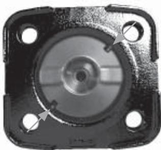
Druckstück lose auf Antriebsspindel aufsetzen, Aussparungen in Führungen einpassen (Pfeile).
