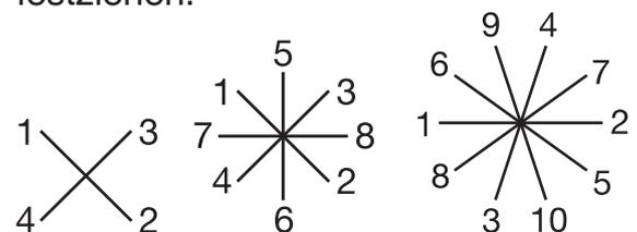
6. Auf gleichmäßige Verpressung der Membrane **2** achten (ca. 10-15 %, erkennbar an gleichmäßiger Außenwölbung).
