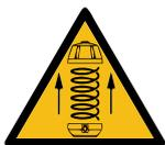
**La partie supérieure de l'actionneur est soumise à une pression de ressort !**
