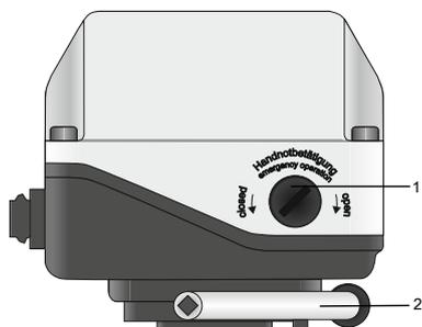
Na lateral do atuador encontra-se uma capa de cobertura **preta**, sob a qual se encontra o acionamento manual de emergência. A manivela para o acionamento manual de emergência encontra-se do lado inferior do atuador. Com a
