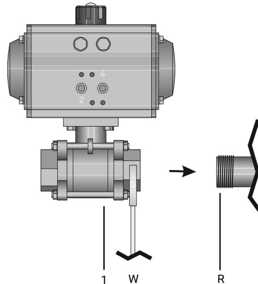
1. Kugelhahnkörper **1** an Rohrleitung **R** anschrauben, geeignetes Gewindedichtmittel verwenden. Das Gewindedichtmittel ist nicht im Lieferumfang enthalten.
