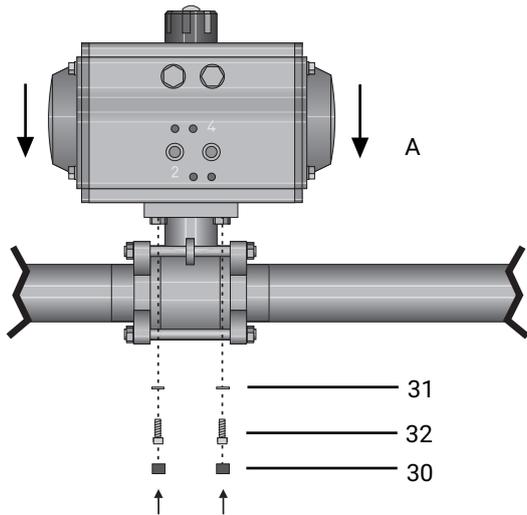
1. Neuen Antrieb **A** auf Kugelhahnkörper stecken.
