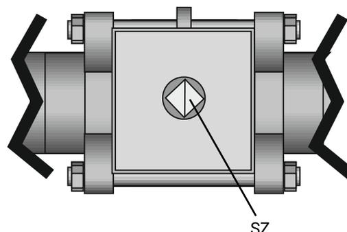
1. Kugelstellung am Schlitz **SZ** ablesen und mit Stellungs-anzeige vergleichen, ggf. Kugelhahn in richtige Position drehen.
