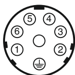
Steckerbelegung X1, UV
