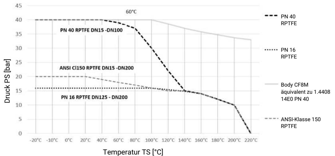
Druck-Temperaturangaben gemäß Diagramm beziehen sich auf statische Betriebsbedingungen. Stark schwankende oder zeitlich schnell wechselnde Parameter können zu einer Verringerung der Standzeit führen. Spezielle Anwendungen sind mit Ihrem technischen Ansprechpartner vorab durchzusprechen.
