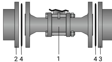
1. Auf saubere und unbeschädigte Dichtflächen der Anschlussflansche achten.
