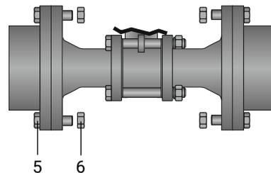
7. Schrauben **5** in alle Löcher am Flansch einführen.
