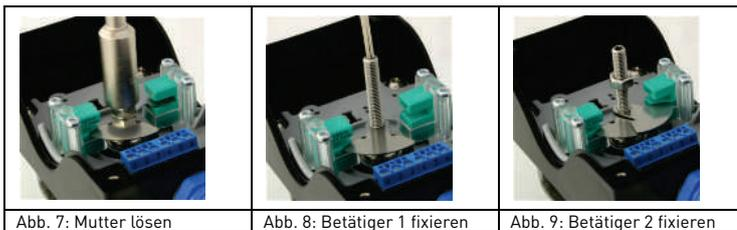
**10. Anschluss von Magnetspulen**
