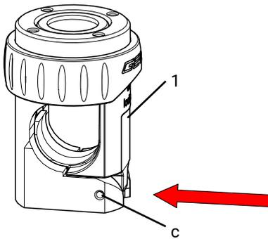
2. Schlauchaufnahme 1 einsetzen.
