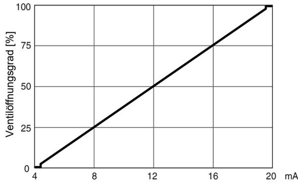
Der Stellungsregler 1441 cPos-X erkennt automatisch, während der Initialisierung, die Steuerfunktion des Ventils und stellt sich standardmäßig so ein, dass bei Signalvorgabe 4 mA, das Ventil geschlossen ist\*.
