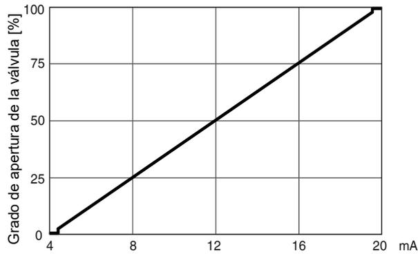
El posicionador 1441 cPos-X detecta automáticamente durante la inicialización la función de mando de la válvula y se ajusta automáticamente para que la válvula esté cerrada cuando se especifica una señal de 4 mA.\*
