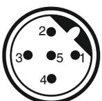
Conector de montaje M12 de 5 polos, codificación B
