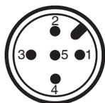
Conector de montaje M12 de 5 polos, codificación A
