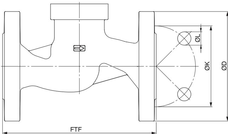
Anschlussart Flansch Baulänge EN 558 (Code 39)<sup>1)</sup>, Feingussmaterial (Code 37), Sphärogussmaterial (Code 90)<sup>2)</sup>
