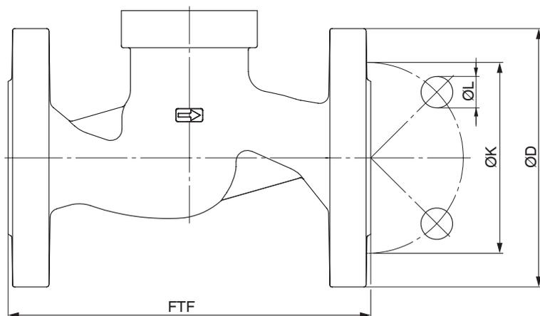
**Anschlussart Flansch Baulänge EN 558 (Code 10)<sup>1)</sup>, Feingussmaterial (Code 37)<sup>2)</sup>**
