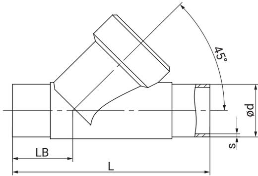
**Type de raccordement embout EN/ISO/ASME (code 17, 60), inox de fonderie (code 37) <sup>1)</sup>**
