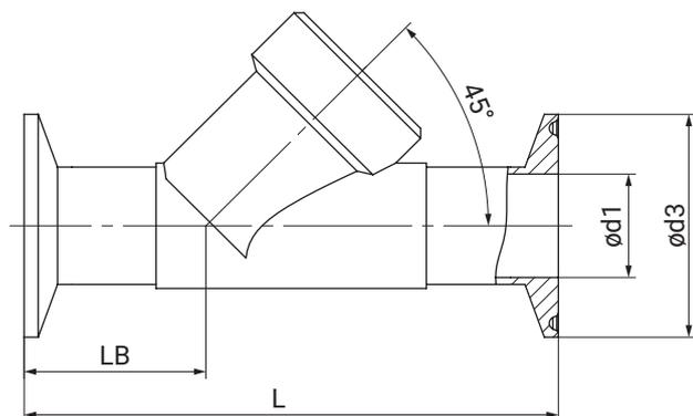
**Type de raccordement clamp DIN/ASME (code 80, 82, 86, 88)<sup>1)</sup>, inox de fonderie (code 34)<sup>2)</sup>**
