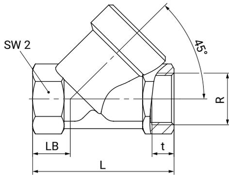
**Type de raccordement orifice taraudé DIN (code 1)<sup>1)</sup>, inox de fonderie (code 37)<sup>2)</sup>**
