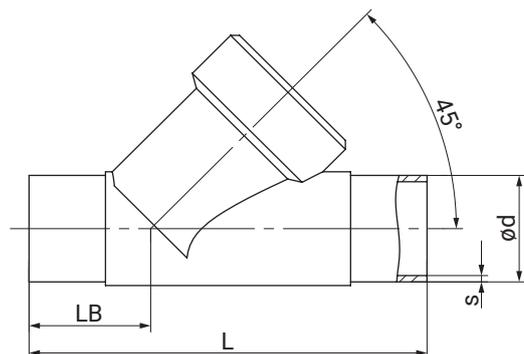
**Type de raccordement embout EN/ISO/ASME (code 17, 59, 60)<sup>1)</sup>, inox de fonderie (code C2)**
