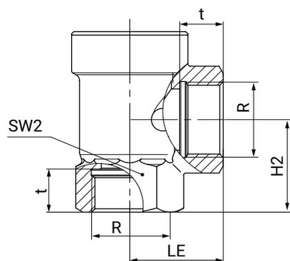
**Type de raccordement orifice taraudé DIN/NPT (code 1, 3D)<sup>1)</sup>, inox de fonderie (code 37)<sup>2)</sup>**
