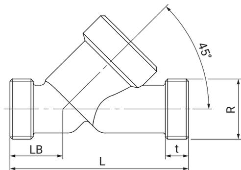
**Type de raccordement embout fileté DIN (code 9)<sup>1)</sup>, inox de fonderie (code 37)<sup>2)</sup>**
