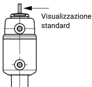
Le valvole ad azionamento pneumatico sono equipaggiate di serie con un indicatore ottico di posizione, che segnala la posizione della valvola APERTA oppure CHIUSA \*).
