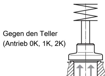
Gegen den Teller ist die zu bevorzugende Durchflussrichtung bei inkompressiblen, flüssigen Medien, um Wasserschläge zu vermeiden
