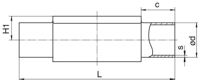
Вид соединения: патрубок DIN/EN/ISO (код 0, 16, 17, 18, 60)<sup>1)</sup>, кованный материал (код 40, 42, F4)<sup>2)</sup>
