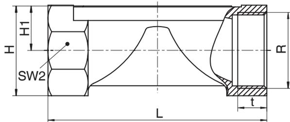
Вид соединения: резьбовая муфта (код 1)<sup>1)</sup>, точное литье (код 37)<sup>2)</sup>,
