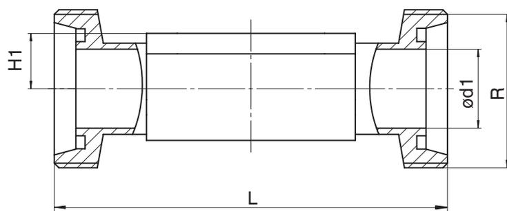
Вид соединения: резьбовой патрубок DIN (код 6)<sup>1)</sup>, кованный материал (код 40, 42)<sup>2)</sup>
