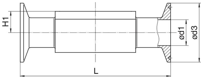
Вид соединения: кламп DIN/ISO (код 82, 8A, 8E)<sup>1)</sup>, кованный материал (код 40, 42, F4)<sup>2)</sup>,
