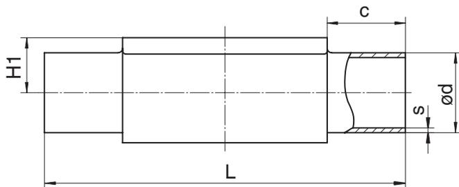
Вид соединения: патрубок JIS/SMS (код 36)<sup>1)</sup>, кованный материал (код 40, 42, F4)<sup>2)</sup>
