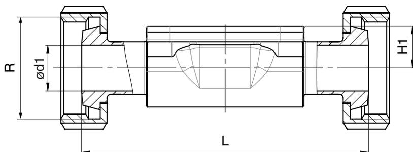
Вид соединения: конический патрубок DIN (код 6K)<sup>1)</sup>, кованный материал (код 40, 42)<sup>2)</sup>
