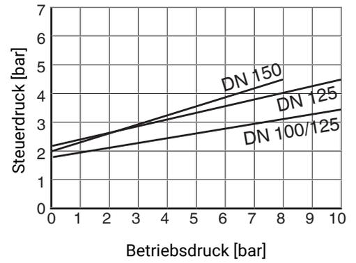
EPDM - Antrieb 0KN, 1KN, 2KN
