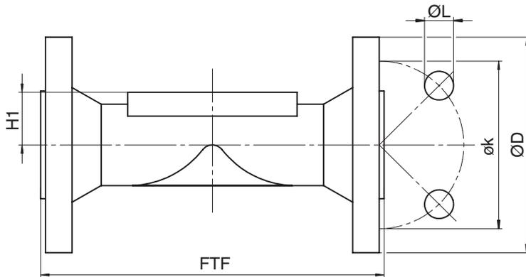
**Anschlussart Flansch Baulänge EN 558 (Code 56), <sup>1)</sup> Sphärogussmaterial (Code 17, 81, 91) <sup>2)</sup>**
