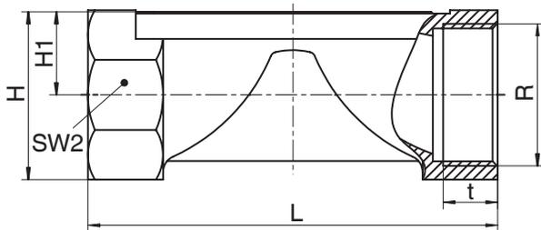
Anschlussart Gewindemuffe NPT (Code 31)<sup>1)</sup>, Sphärogussmaterial (Code 90)<sup>2)</sup>
