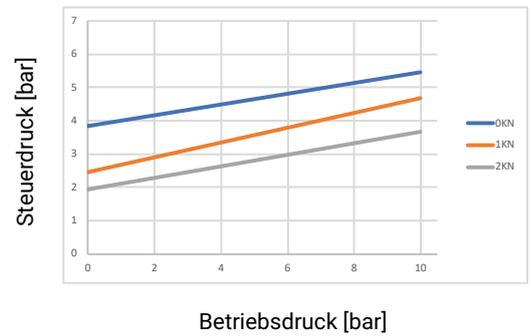
Hinweis: In oben stehenden Diagrammen ist bei den Antrieben „unter Federkraft geöffnet“ (Steuerfunktion 2) der minimal notwendige Steuerdruck in Abhängigkeit vom Betriebsdruck angegeben.
