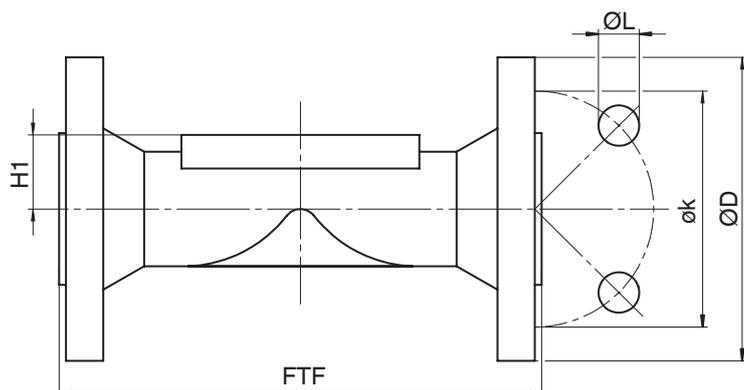
**Type de raccordement bride, encombrement 558 (code 34)<sup>1)</sup>, inox de fonderie (code 39)<sup>2)</sup>**
