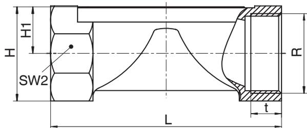
Type de raccordement orifice taraudé NPT (code 31)<sup>1)</sup>, inox de fonderie (code 37)<sup>2)</sup>
