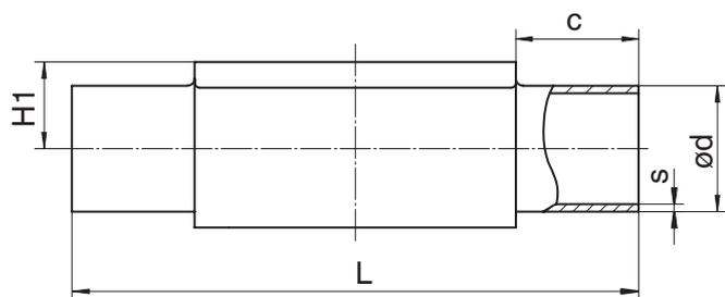
Type de raccordement embout DIN/EN/ISO (code 0, 17, 60)<sup>1)</sup>, inox de fonderie (code C3)<sup>2)</sup>
