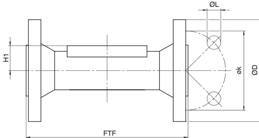
Type de raccordement bride, encombrement EN 558 (code 58)<sup>1)</sup>, fonte grise (code 8), fonte sphéroïdale (code 16, 92, 98)<sup>2)</sup>
