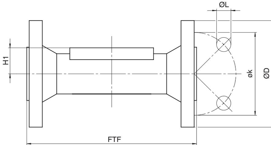
**Type de raccordement bride, encombrement EN 558 (code 8)<sup>1)</sup>, fonte sphéroïdale (code 82, 83, 88)<sup>2)</sup>**
