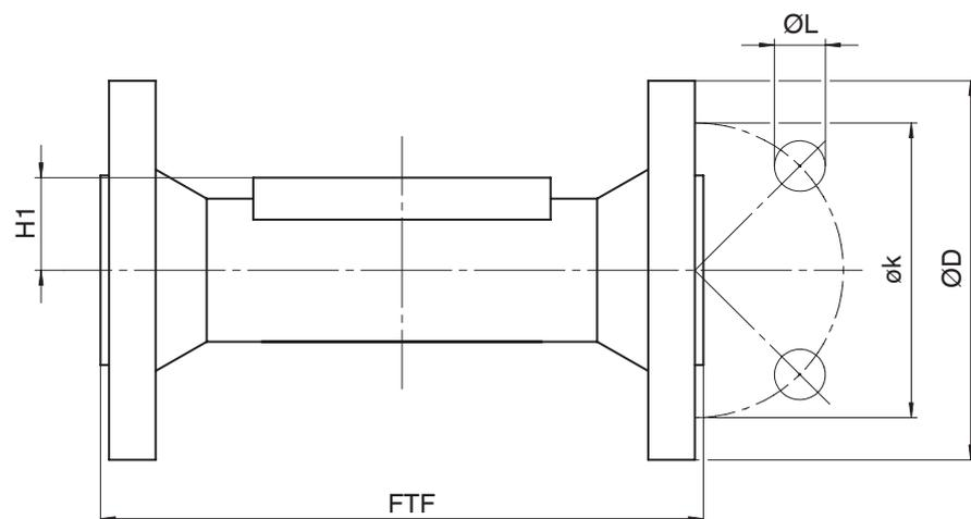
Type de raccordement bride, encombrement EN 558 (code 52)<sup>1)</sup>, fonte grise (code 8), fonte sphéroïdale (code 16, 92, 98)<sup>2)</sup>
