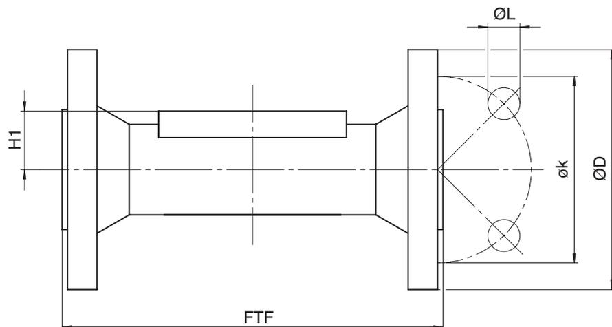
Type de raccordement bride, encombrement EN 558 (code 53)<sup>1)</sup>, fonte grise (code 8), fonte sphéroïdale (code 16, 92, 98)<sup>2)</sup>
