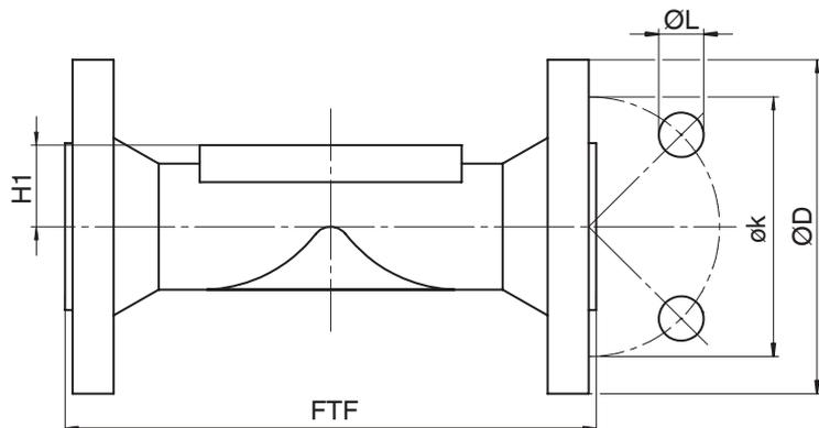
**Anschlussart Flansch Baulänge EN 558 (Code 51), <sup>1)</sup> Sphärogussmaterial (Code 17, 81, 91) <sup>2)</sup>**
