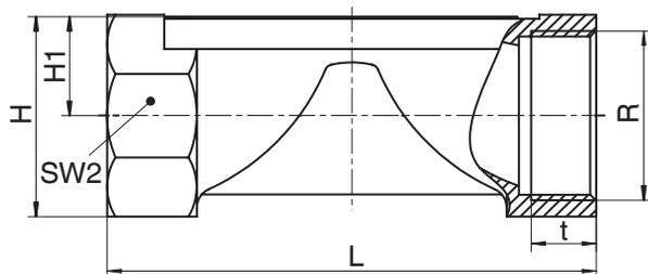
**Anschlussart Gewindemuffe (Code 1)<sup>1)</sup>, Sphärogussmaterial (Code 90)<sup>2)</sup>**
