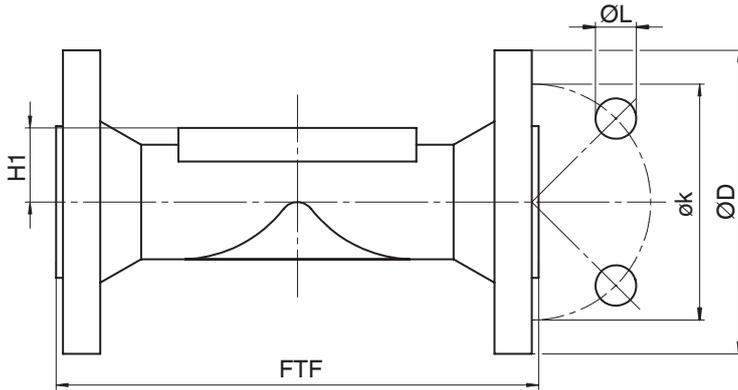
**Anschlussart Flansch Baulänge EN 558 (Code 53)<sup>1)</sup>, Graugussmaterial (Code 8), Sphärogussmaterial (Code 17)<sup>2)</sup>**
