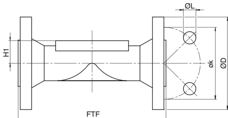
**Anschlussart Flansch Baulänge EN 558 (Code 39), <sup>1)</sup> Sphärogussmaterial (Code 17, 18, 82, 83, 88, 90)<sup>2)</sup>**
