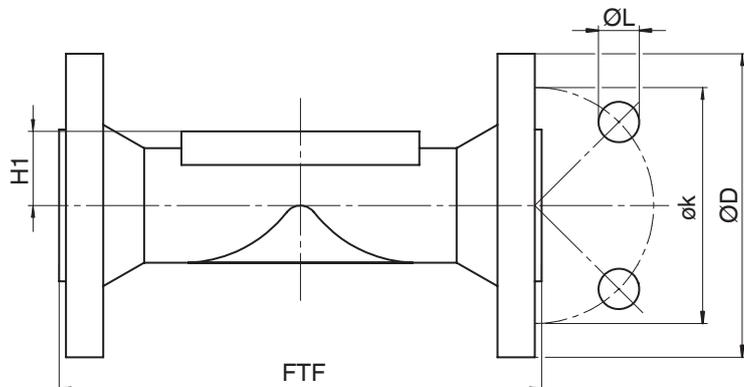
**Tipo de conexión brida, longitud EN 558 (código 39),<sup>1)</sup> material de fundición nodular (código 17, 18, 82, 83, 88, 90)<sup>2)</sup>**
