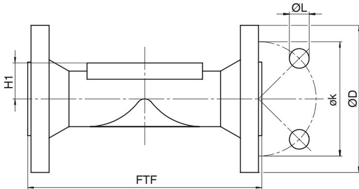
Tipo de conexión brida, longitud EN 558 (código 56), <sup>1)</sup> material de fundición nodular (código 17, 81, 91) <sup>2)</sup>
