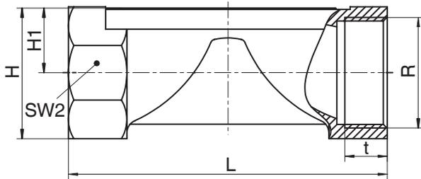
**Tipo de conexión rosca hembra (código 1)<sup>1)</sup>, material de fundición nodular (código 90)<sup>2)</sup>**
