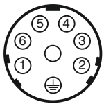
Распределение штекерных контактов UV
