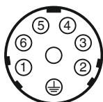
Распределение контактов в штекере X1, UV
