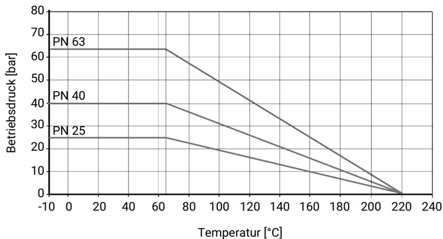
Druck-Temperaturangaben gemäß Diagramm beziehen sich auf statische Betriebsbedingungen. Stark schwankende oder zeitlich schnell wechselnde Parameter können zu einer Verringerung der Standzeit führen. Spezielle Anwendungen sind mit Ihrem technischen Ansprechpartner vorab durchzusprechen.
