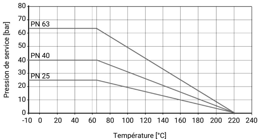
Les données de température/de pression selon le diagramme sont valables pour des conditions d'utilisation statiques. Des paramètres très fluctuants ou variant rapidement dans le temps peuvent entraîner une diminution de la durée de vie. Vous devez parler des applications spéciales au préalable avec votre interlocuteur technique.
