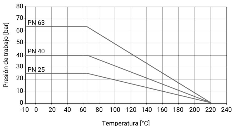
Las indicaciones de presión y temperatura según el diagrama se refieren a las condiciones de trabajo estáticas. Los parámetros muy fluctuantes o que cambian rápidamente con el tiempo pueden reducir la vida útil. Las aplicaciones especiales deben discutirse previamente con su interlocutor técnico.
