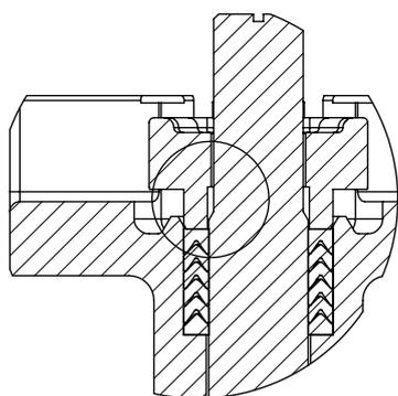
Na extremidade superior do eixo encontra-se uma chanfradura como medida de segurança adicional no caso de quebra do eixo.
