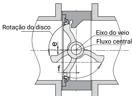
Durante a operação, o disco é desconectado diretamente do assento no que a fricção entre assento e disco é diminuída e o torque reduzido.
