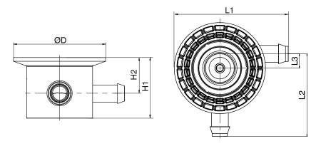
Type de raccordement embout cannelé (code HB)
