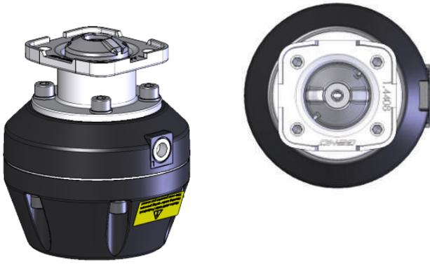
8. Der Antrieb ist nun auf das neue QHD-Zwischenstück mit aktuellem innen geführtem Druckstück umgerüstet.
