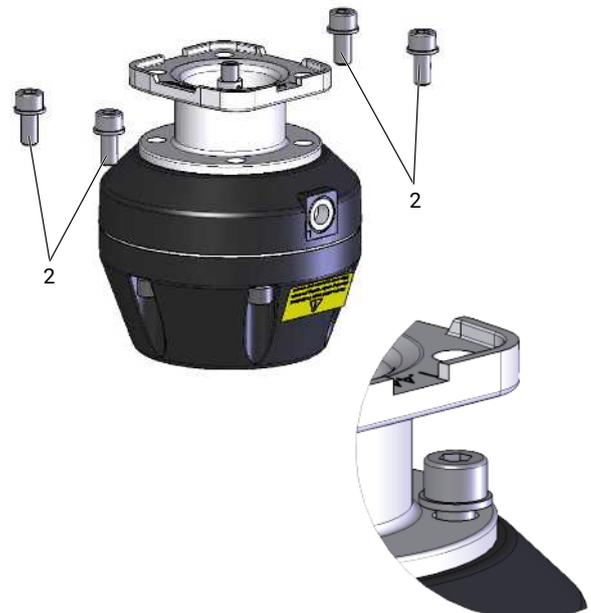
2. 4 Zylinderschrauben (2) mit integrierter Unterlegscheibe (Kombischraube) montieren.
