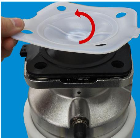
1. PTFE-Membranschild von Hand umklappen und von der Ventilschindel / dem Druckstück abschrauben (Rechtsgewinde: zum Lösen links herum drehen).
