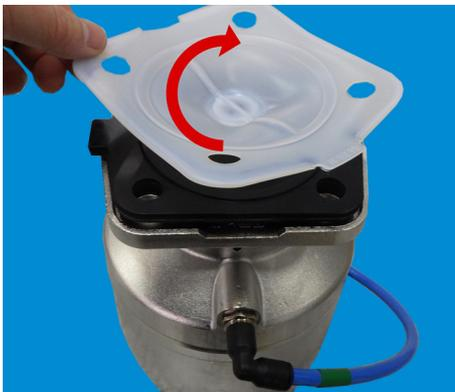
1. EPDM-Stützmembrane passgenau auf den Antriebsflansch legen.
