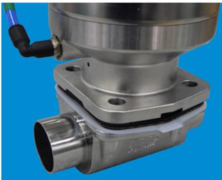
1. Antrieb mit montierter Membrane auf Ventilkörper aufsetzen.
