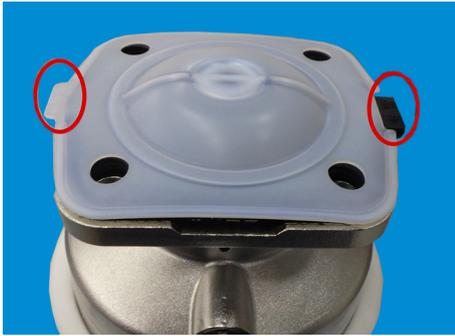
1. PTFE-Membranschild bis zur nächstmöglichen Übereinstimmung zurückdrehen (max. 180°).
