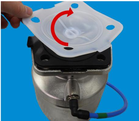
1. EPDM-Stützmembrane passgenau auf den Antriebsflansch legen.
