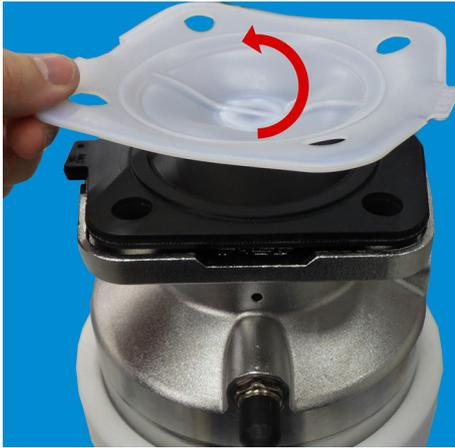
1. PTFE-Membranschild von Hand umklappen und von der Ventilspindel / dem Druckstück abschrauben (Rechtsgewinde: zum Lösen links herumdrehen).
