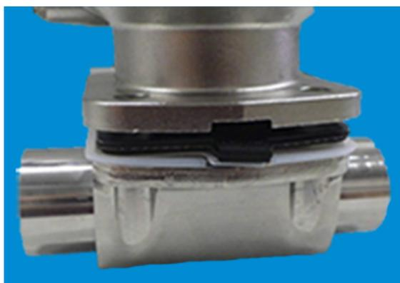
1. Antrieb mit montierter Membrane auf Ventilkörper aufsetzen.
