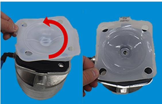
1. PTFE-Membranschild von Hand umklappen und von der Ventilspindel / dem Druckstück abschrauben (Rechtsgewinde: zum Lösen links herumdrehen).
