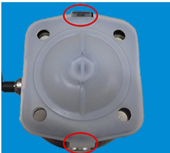
1. PTFE-Membranschild bis zur nächstmöglichen Übereinstimmung zurückdrehen (max. 180°).
