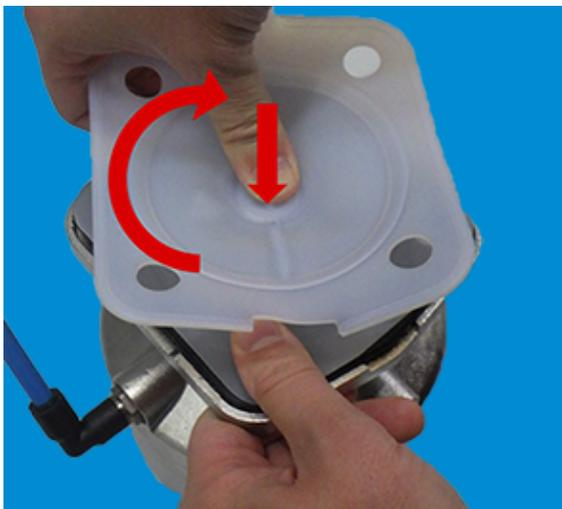
1. PTFE-Membranschild von Hand umklappen und in die Ventilspindel / das Druckstück bis zum Anschlag einschrauben.
