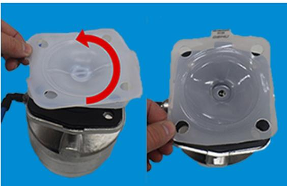
1. Inverser à la main la feuille PTFE et la dévisser de l'axe de la vanne/du sabot (filetage à droite : tourner vers la gauche pour desserrer).
