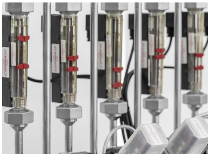
Medidores de vazão
